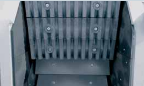
Verschleißkosten weit unter Durchschnitt: durch optimierte Brecherkinematik und verschleißfeste, Bruchfördernde Werkstoffe.
