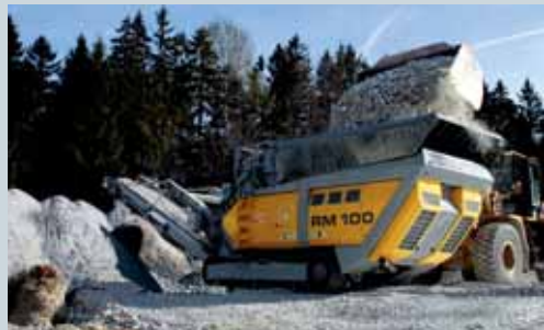
250 t/h homogenes Endkorn 0/70 mm: der RM100 beweist seine Stärke als Primärbrecher in der Kiesgrube.
