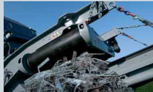
Vollständiger Stahlaustrag: durch den extra groß dimensionierten Magnetabscheider.
