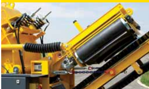
Unverzichtbar: Release-System zur Blockagenbeseitigung und zuverlässiger Magnetabscheider
