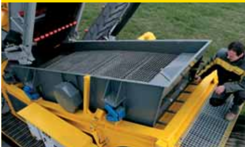
Großflächige Siebbox mit 2 gleich großen Decks für höchste Effizienz und kurze Rüstzeiten
