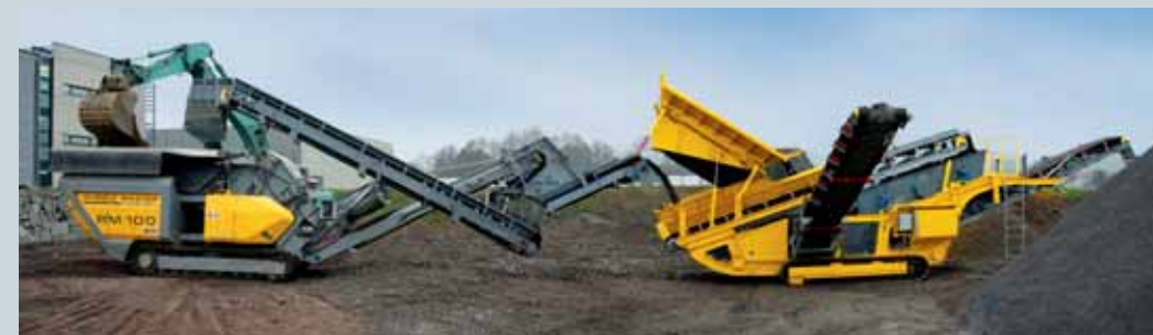
4 Körnungen in einem Arbeitsgang im Power-Paket mit RM100 und OS100 - oder 3 definierte Wertkörnungen bei Überkornrückführung.
