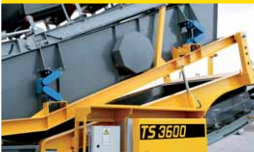
Neigungswinkel hydraulisch bis 25° verstellbar für kritisches und feines Material
